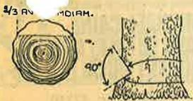
Fallhugget utføres med tildels retnings skjær og underskjær. Fallhuggets åpning skal være minst 90° for å styre treet rett ned, og bredden skal være minst 2/3 av stammens diameter.
